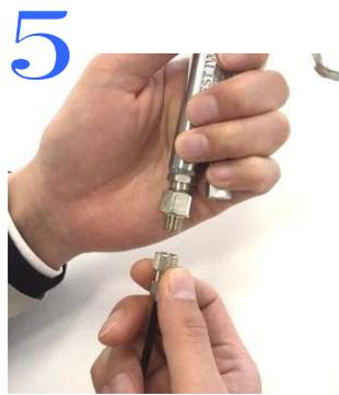
デコエアに付属している変換ジョイントを接続し、ストレートホースの反対側にデコエアを接続します。
