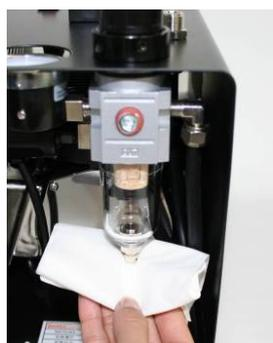
フィルタレギュレータの底部にあるつまみを押し上げます。
