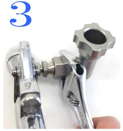
3 液体カップを外し、洗浄します。
