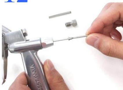
ニードル弁を挿入します。(ゆっくり挿入し、ノズル先端からニードル弁が突き出るまで押し込んでください。)
