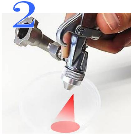
2 使用した液体に適した洗浄液を入れ、材料調節つまみを全開にし、捨て吹きをします。噴出される液体がきれいになるまで繰り返し洗浄します。
