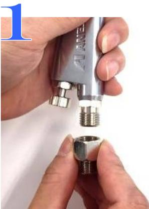
デコエアに付属している変換ジョイントを接続します。
