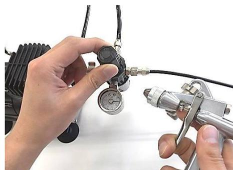
デコエアーのトリガーを引き、エア(圧縮空気)を噴出させながら調節してください。
