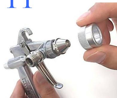
空気キャップを取り付けカバーを取り付けます。
