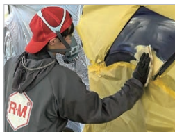
マスクング後、再度塗装箇所を十分に脱脂・清掃しエアブローする
