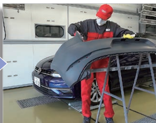
ブラサフ塗装を強制乾燥させている間に、リヤバンパーを足付け研磨し脱脂・清掃する
