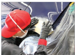
手研ぎ(空研ぎ)後に、ダブルアクションサンダーで研磨
