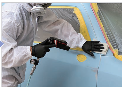
イオン発生機付きブロアーガンでエアブローし、ゴミやホコリなどを取り除く
