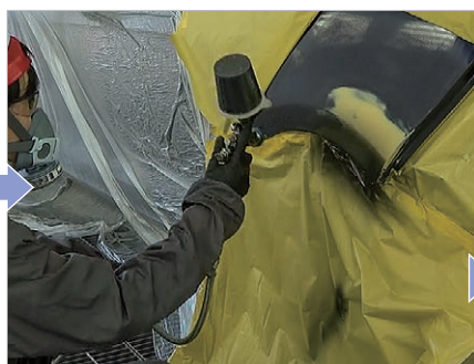
左リヤフェンダーのブラサフ塗装範囲を中心に、黒色のカラーブラサフを下から上に吹き付ける。口径は1.4mm。エア圧は0.17~0.18MPa、吐出量は全閉から4回転
