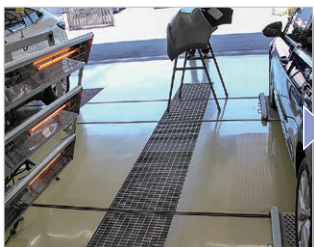
ブラサフ塗装を強制乾燥させている間に、リヤバンパーを足付け研磨し脱脂・清掃する
