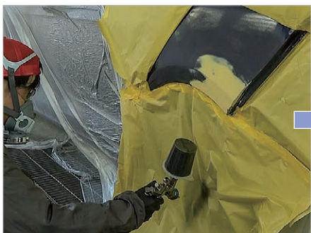
マスクングペーパーに吹き付け、吐出量とパターンを確認
