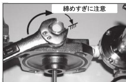
10. 新しいカートリッジとガスケットを取り付けます
